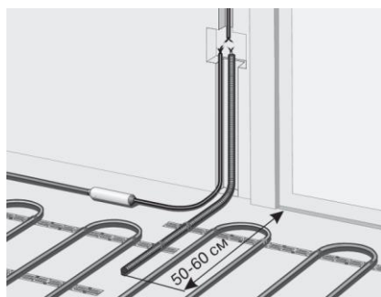
Рисунок 1 – Подключение греющего кабеля и термодатчика.
