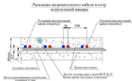
Датчики контролируют температурный режим грунта и включает электрообогрев, когда это необходимо, экономя тем самым электроэнергию. Как и все системы обогрева, системы подогрева грунта под фундаментом морозильных камерах легко монтируются и не требуют специального оборудования. Нижний температурный порог грунта  $+2^{\circ}\text{C} \dots +4^{\circ}\text{C}$ . Система не нуждается в обслуживании. В качестве контроля работы системы достаточно проверять наличие питания сети электроэнергии.
