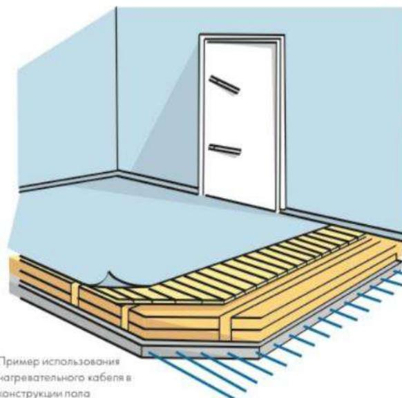
Пример использования нагревательного кабеля в конструкции пола морозильной камеры.
